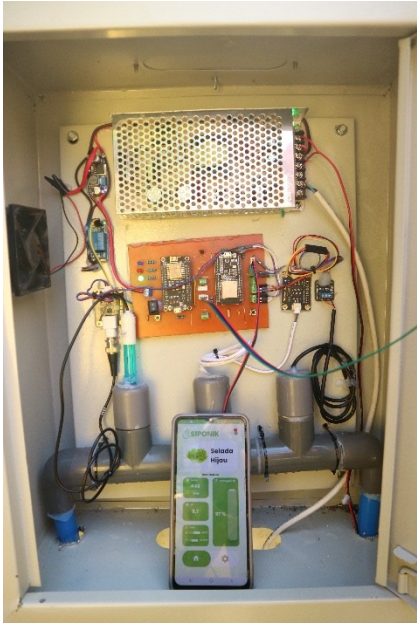
Gambar 1. Alat Parameter IoT dan Aplikasi SIPONIK
